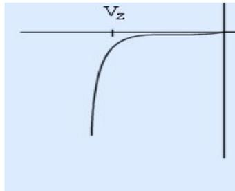
In questo caso possiamo notare che quando il diodo è collegato inversamente attraverso di esso circola una corrente molto bassa quasi nulla, in pratica si comporta come una resistenza di valore elevatissimo.
