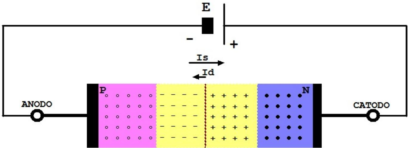
Applicando una tensione in senso opposto, la zona di svuotamento si allarga e gli elettroni non riusciranno a passare dalla zona N alla zona P.
