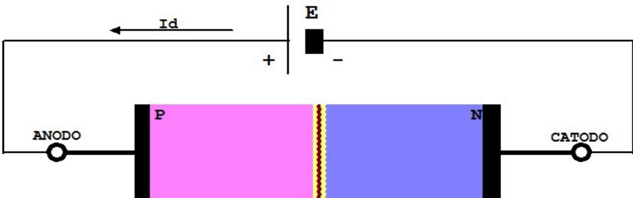
Perciò una polarizzazione diretta di una giunzione PN, causa una riduzione della zona di svuotamento e della sua barriera potenziale (dV) la corrente di diffusione diventa molto più grande della corrente di drift ed essendoci una riduzione della barriera di potenziale non ci sarà più una limitazione della corrente, pertanto la giunzione si comporterà come un normale conduttore.
