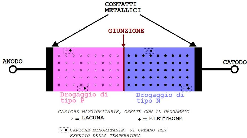
Effettuando questo diverso drogaggio, avverrà che in prossimità della giunzione le lacune della zona di tipo P verranno colmate dagli elettroni liberi della zona di tipo N, con una “**corrente di diffusione**” che cesserà quando gli elettroni della zona di tipo N (a destra) verranno contrapposti dalla carica negativa che si è venuta a creare nella zona di tipo P (a sinistra).
