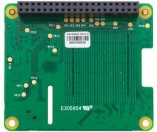
La scheda si interfaccia con la Raspberry tramite l'I2C e l'SPI, in tutti i piedini utilizzati sono quelli in figura.
