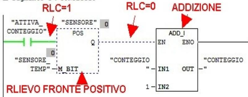
Il PLC esegue tutte le righe simultaneamente, pertanto appena il bit ATTIVA\_CONTEGGIO va ad uno, nel terzo segmento, il Risultato Logico Combinatorio del test dello stesso bit va ad uno, e si attiva il blocco RILIEVO FRONTE POSITIVO.
